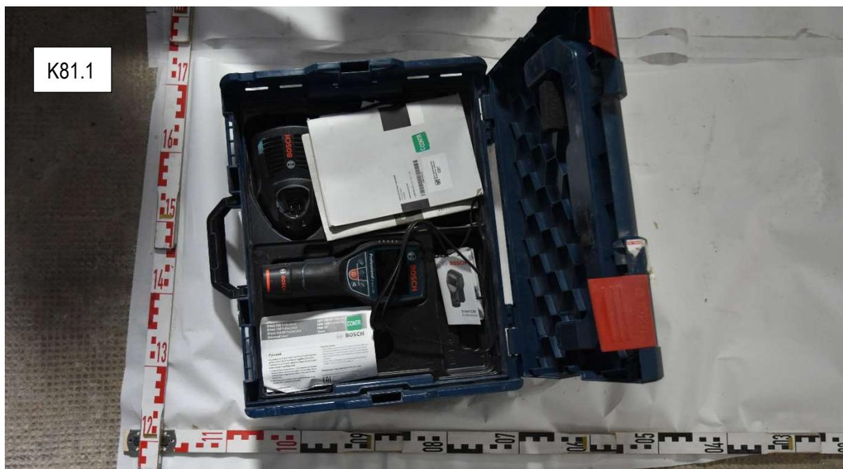
Inhalt Koffer BOSCH: Leitungsdetector d-tect120 professional
